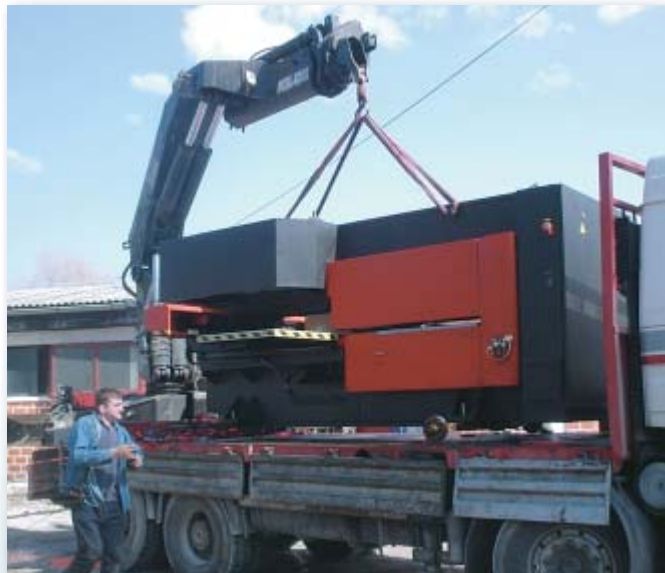
Ukrcavanje CNC štanice
